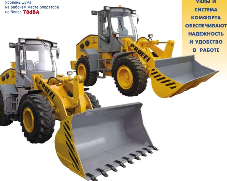
Автоматизированный кинематический возврат ковша из положения разгрузки в положение набора грунта.
