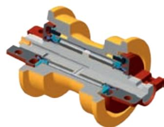
**Опорные катки** на подшипниках скольжения, спроектированных по классической схеме, где в качестве антифрикционного материала используется бронза.
