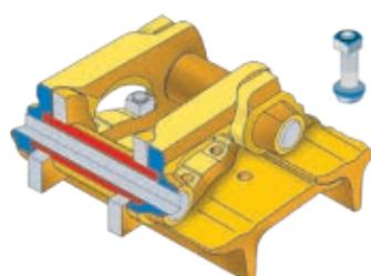
**Гусеница с уплотненным и смазанным шарниром,** башмаком из стали с высокими физико-механическими свойствами, закрепленными специальными болтами.
