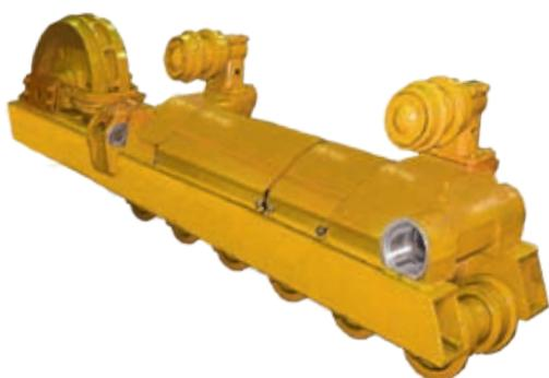
Ресурс ходовой системы увеличился благодаря применению опорных катков с подшипниками скольжения, уплотнений «Duo Cone», обеспечивающих работу опорных катков без подтекания масла, сегментных ведущих колес и гусениц с уплотненным смазанным шарниром.
