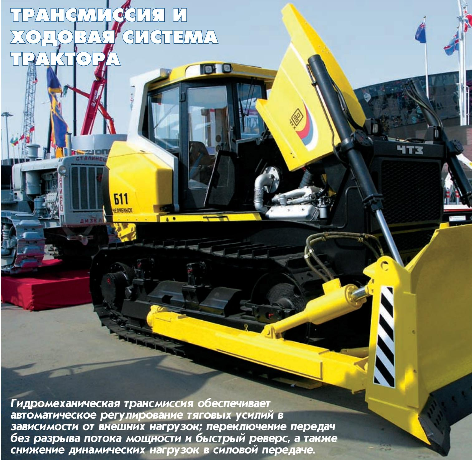
**Гидромеханическая трансмиссия обеспечивает автоматическое регулирование тяговых усилий в зависимости от внешних нагрузок; переключение передач без разрыва потока мощности и быстрый реверс, а также снижение динамических нагрузок в силовой передаче.**
