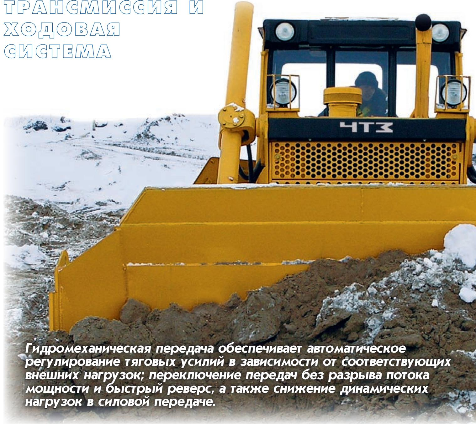
**Гидромеханическая передача обеспечивает автоматическое регулирование тяговых усилий в зависимости от соответствующих внешних нагрузок; переключение передач без разрыва потока мощности и быстрый реверс, а также снижение динамических нагрузок в силовой передаче.**
