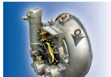
**Планетарная коробка передач** имеет 3 передачи вперед и 3 передачи назад с гидроприводом для переключения передач и реверса.
