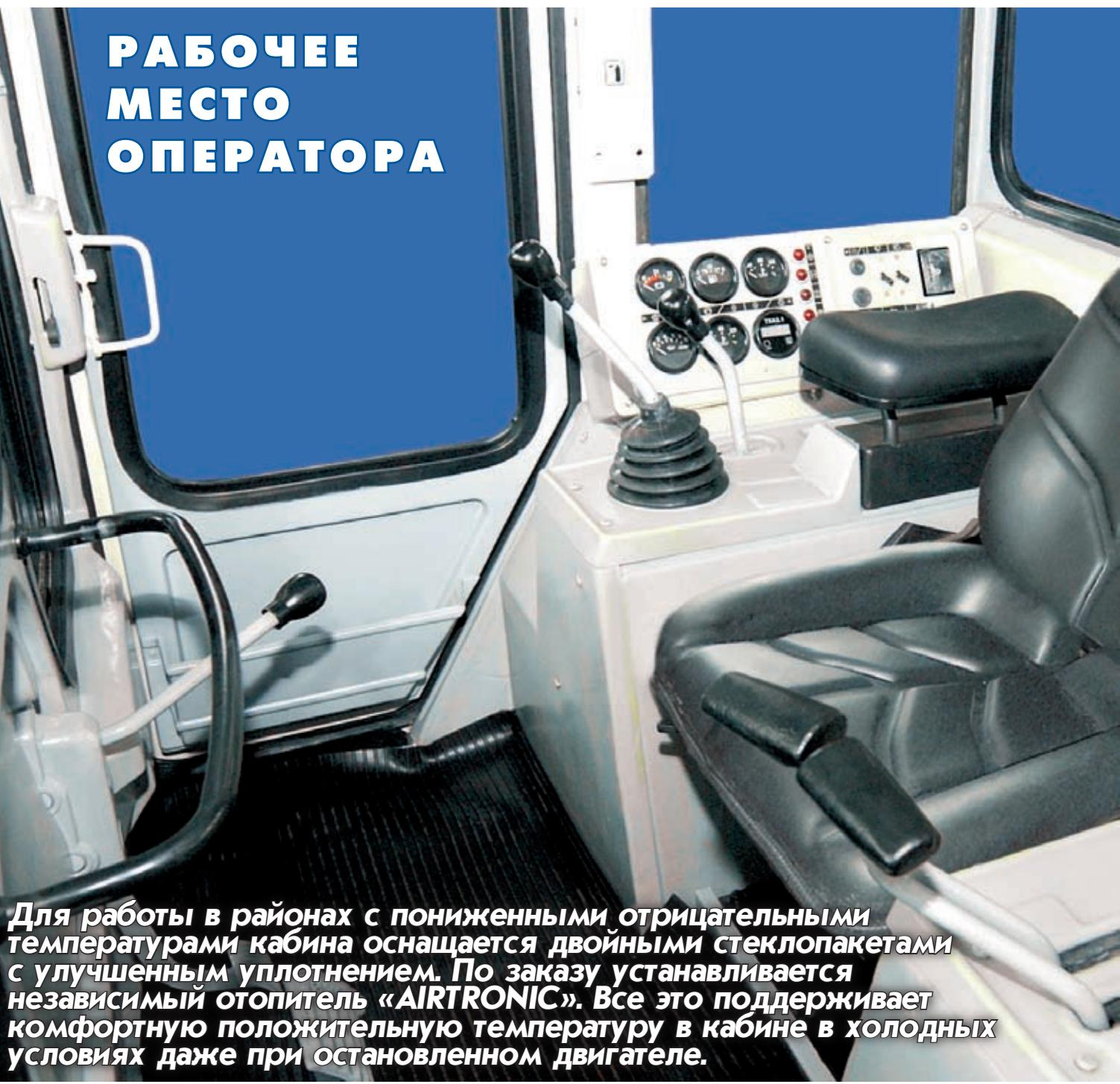
**Для работы в районах с пониженными отрицательными температурами кабина оснащается двойными стеклопакетами с улучшенным уплотнением. По заказу устанавливается независимый отопитель «AIRTRONIC». Все это поддерживает комфортную положительную температуру в кабине в холодных условиях даже при остановленном двигателе.**
