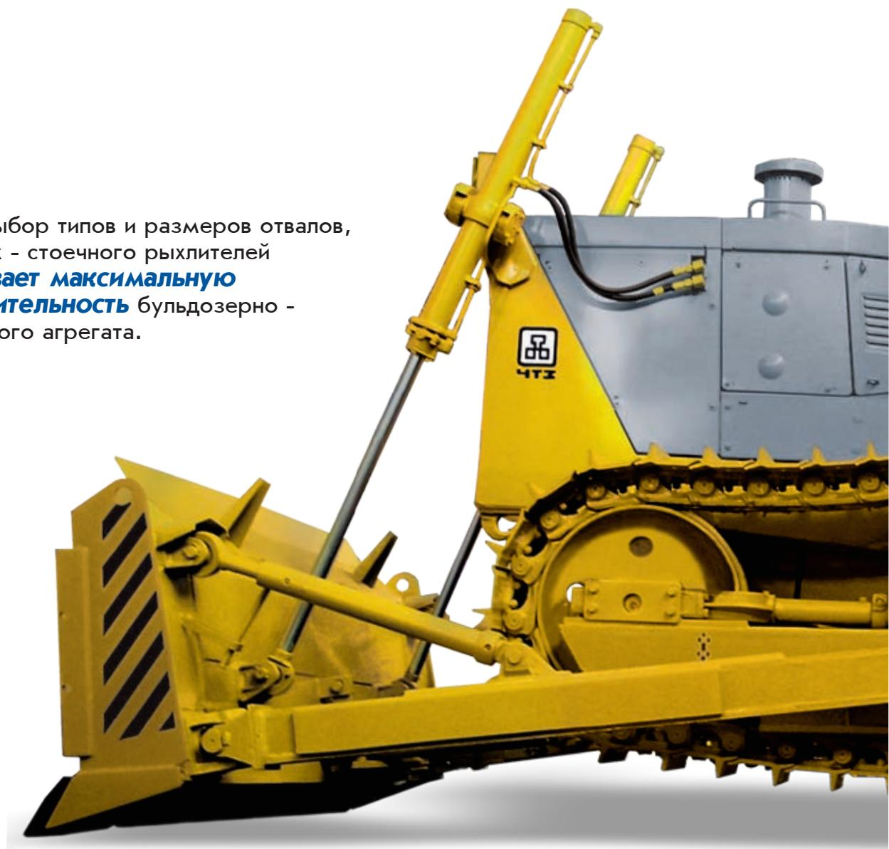
**Ходовая система** с жесткой поперечной балкой и микроподпрессориванием. Направляющие колеса, опорные и поддерживающие катки **с уплотнением типа «Duo Cone»**. Опорные катки на подшипниках скольжения.
