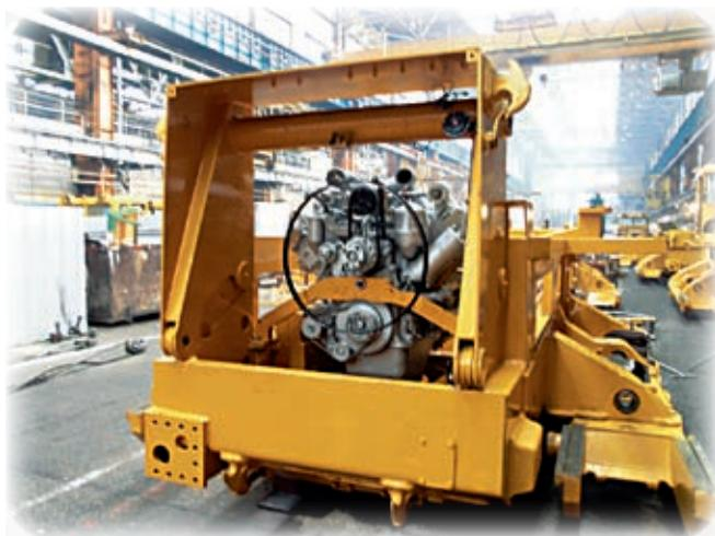
**Для увеличения ресурса ходовой части усилены лонжероны рамы тележки, введены торсионы равной жесткости, замкнутые на раму тележки, вместо рамы трактора.**
