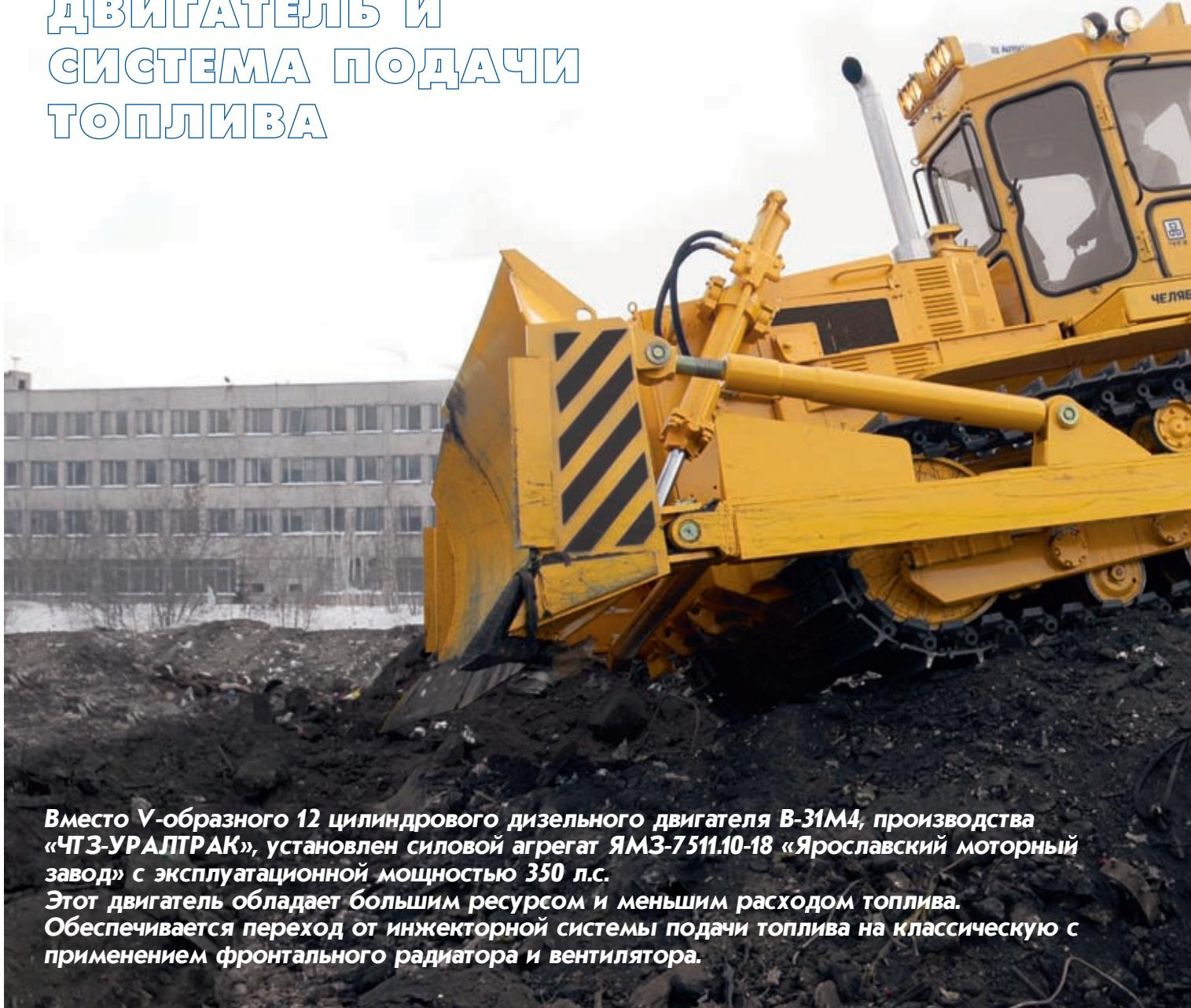
**Вместо V-образного 12 цилиндрового дизельного двигателя В-31М4, производства «ЧТЗ-УРАЛТРАК», установлен силовой агрегат ЯМЗ-7511.10-18 «Ярославский моторный завод» с эксплуатационной мощностью 350 л.с.**
