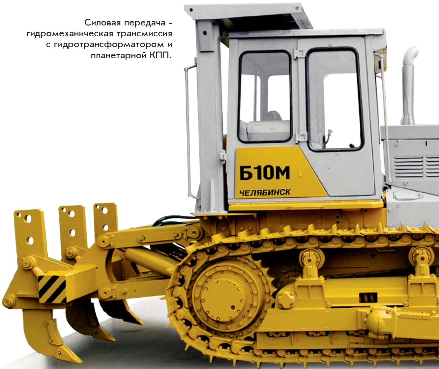
Подвеска ходовой части с вынесенной осью прокачки тележек и балансирной балкой.
