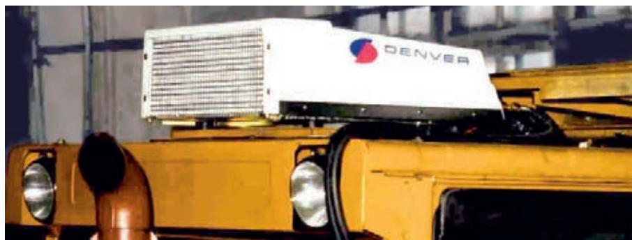
**Кабина оснащается отопителем-вентилятором «ZENIT-8000», использующим тепло охлаждающей жидкости двигателя.**
